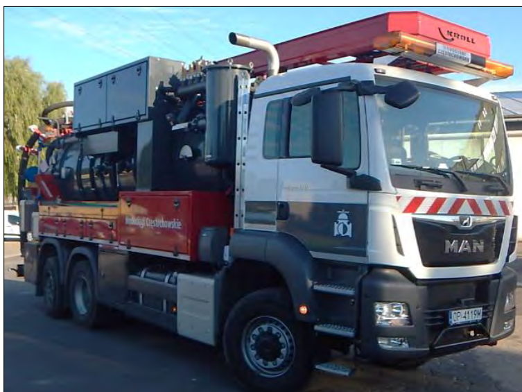
Ryc. 1. Specjalistyczny samochód ciśnieniowy z systemem odzysku wody
